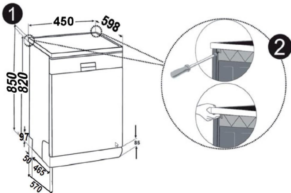
Внимание. Стационарная часть, под которую устанавливается машина путем удаления верхней крышки, должна быть устойчивой и не допускать нарушения балансировки. Чтобы снять верхнюю панель, выкрутите удерживающие ее винты, расположенные в задней части машины; затем сдвиньте переднюю панель на 1 см назад и снимите ее.
