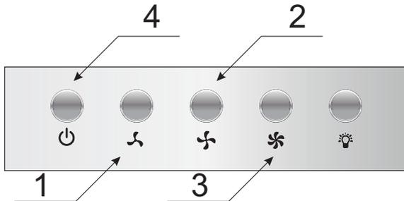
Басқару панелі түймелермен қамтылған (isostat). Сүзіндіні қосу үшін, тиісті түймені басу арқылы төменде сипатталған жылдамдық режимдерінің бірін таңдаңыз:
